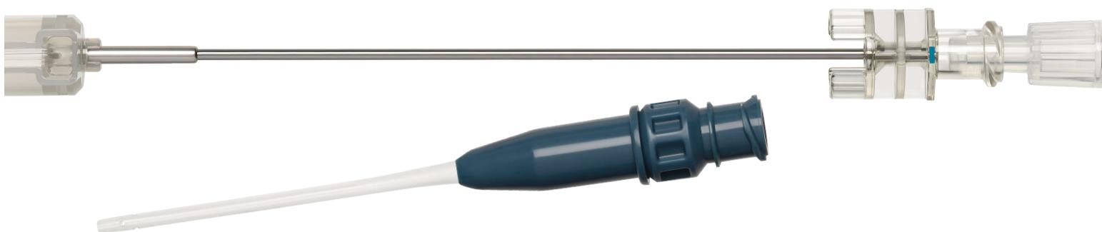
La cánula para fístula Argyle™ tiene dos partes – una **aguja** filosa y una **cánula** roma de propileno. Una vez que se retira la aguja, se activa el mecanismo de seguridad cubriendo la punta filosa, dejando solo la cánula para la hemodiálisis. Esta función está diseñada para prevenir lesiones por punciones con agujas durante el procedimiento de hemodiálisis.
